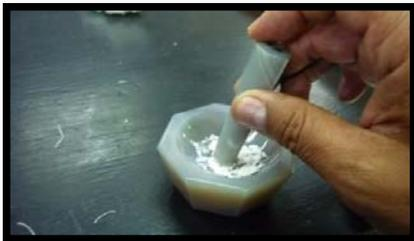
Figura 7. Mezcla y molienda de los tres componentes
